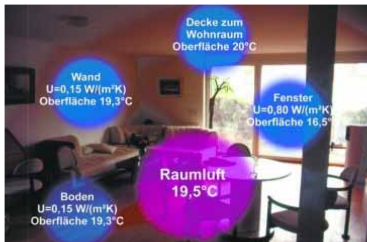
Hohe Behaglichkeit und ausgeglichene Temperaturen bei guter Wärmedämmung
