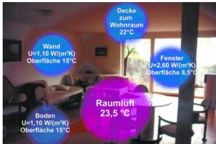
Oberflächentemperatur und Raumtemperatur bei schlechter Dämmung
