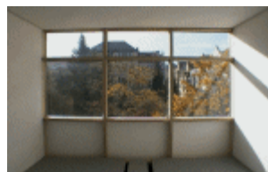
Thermotrope Verglasung in Modellraum (Fotos: H. Hartwig, TU München)
