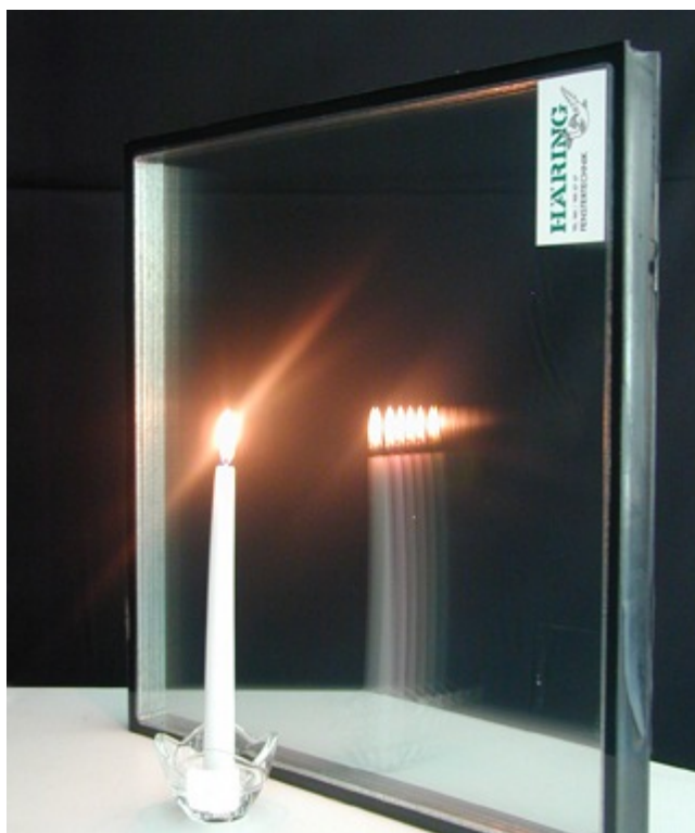
In der Forschung: 4-Folien-Verglasung mit einem Wärmeverlustrkoeffizient von nur 0,17 (Fa. Häring Fenster + Fassaden, CH)
