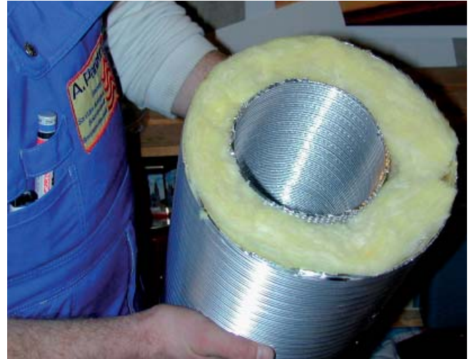
Ein Schalldämpfer ohne Abdeckblech: Innen das feingelochte Wellrohr, darum die Schallschluckmatte.
