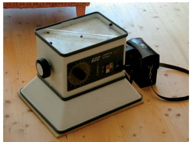
Ein Messgerät zur Bestimmung der Volumenströme an Zu- und Abluftventilen
