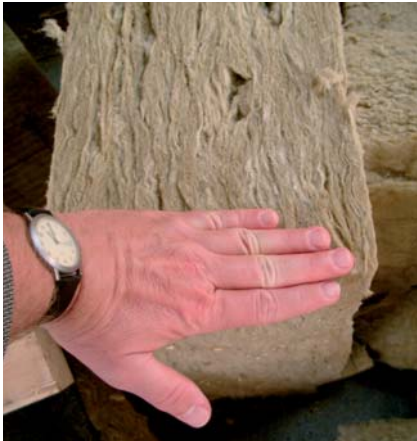
Dämmstoff mit I-Wert 0,035 auswählen
